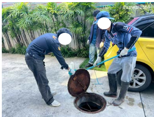
ภาพที่ 3.5-3.6 แสดงการเก็บตัวอย่างน้ำผ่านการบำบัด บ่อเก็บน้ำทิ้ง (Reuse)
