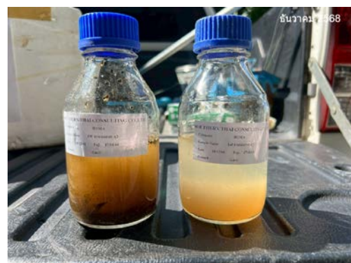
ภาพที่ 3.1-3.2 แสดงการเก็บตัวอย่างน้ำเข้าระบบบำบัด และน้ำผ่านการบำบัด (อาคาร A จุดที่ 2)
