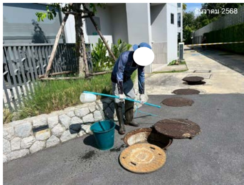
ภาพที่ 3.3-3.4 แสดงการเก็บตัวอย่างน้ำเข้าระบบบำบัด และน้ำผ่านการบำบัด (อาคาร A จุดที่ 3)
