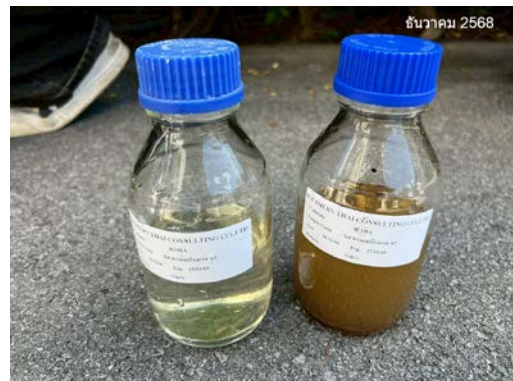
ภาพที่ 3.3-3.4 แสดงการเก็บตัวอย่างน้ำเข้าระบบบำบัด และน้ำผ่านการบำบัด (อาคาร A จุดที่ 3)
